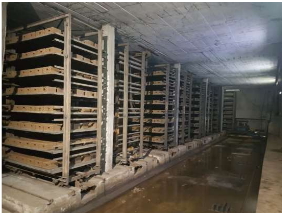
Slika 26. Tunelska sušara
