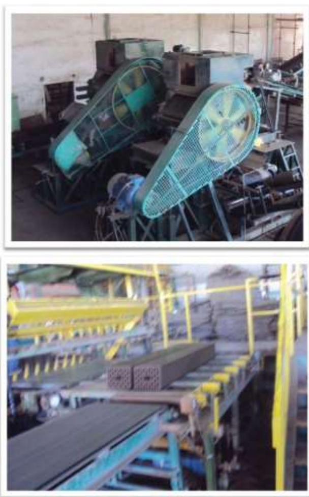
Slika 23. Mlinovi 1 i 2 (levo) i oblikovanje glinenih proizvoda (desno)
