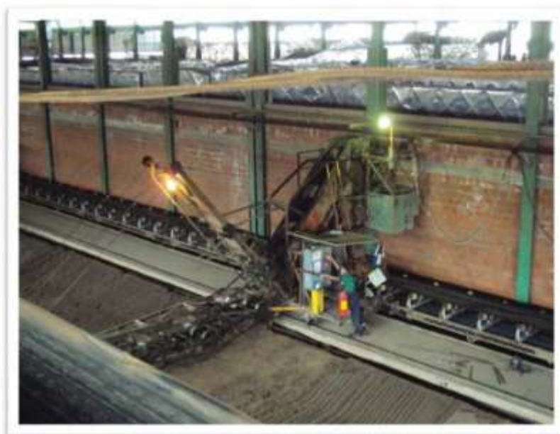
Slika 22. Bager vedričar na unutrašnjem odležavalištu-bazenu
