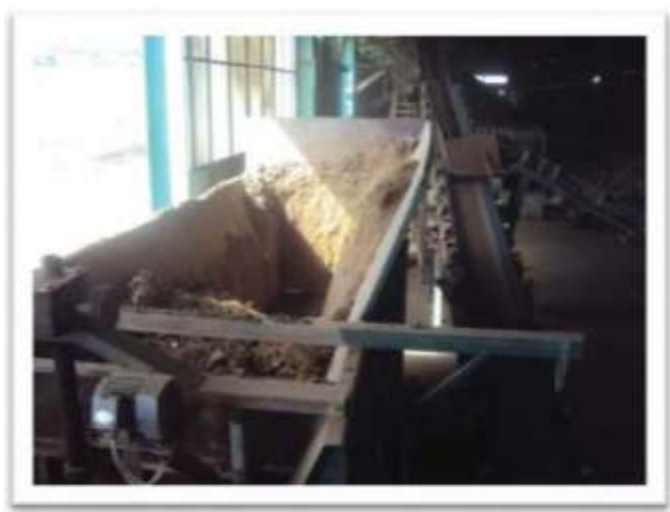
Slika 19. Bunker za prijem gline
